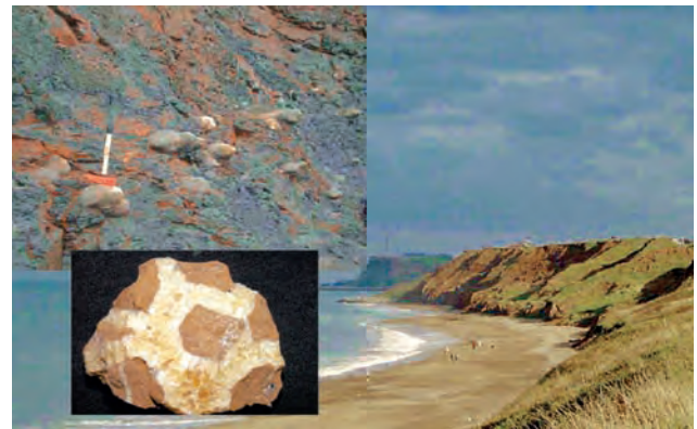
Fig. 3 - Nódulos de Septaria de las escolleras de Harwich (UK) usados por Parker para fabricar Cemento Romano
